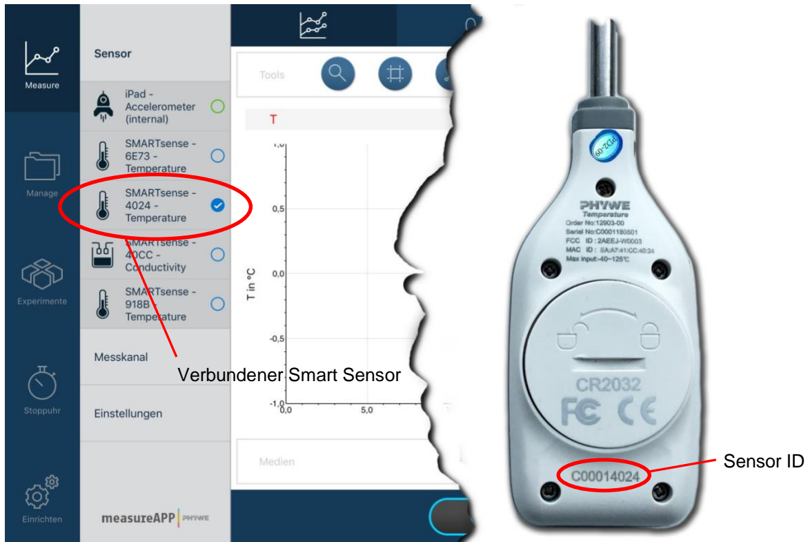
Abb. 48 Verbindungsaufbau mit SMART sense Temperature
